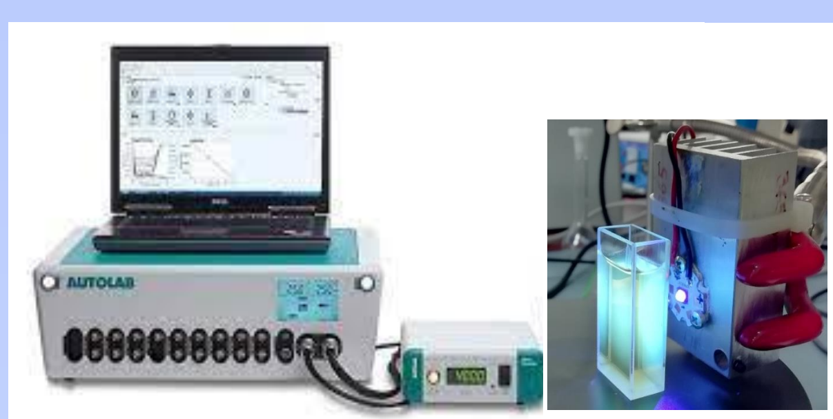
Zestaw laboratoryjny do badań fotoelektrokatalitycznych
